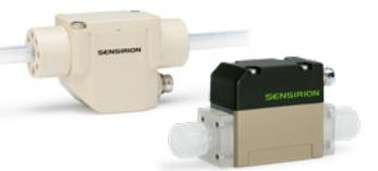
**SLQ**：120 mL/min の校正流量範囲と高純度接液材料 (石英ガラス、PFA) の使用により、半導体産業における要求の厳しい塗布プロセスや、高粘度の液体や粒子を含む液体の測定に最適です。
