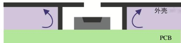
图 2 将传感器隔室与其余外壳隔开，可最大限度减少原有空气对传感器的影响。
